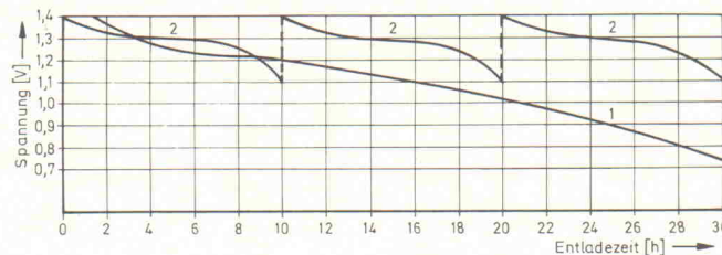
Bild 6. Alkali-Trockenzelle gegen NiCd-Zelle: Das unterschiedliche Entladeverhalten der beiden Systeme, bei gleichen Abmessungen und gleicher Belastung. Die Alkali-Zelle hat den dreifachen Energiegehalt, aber nach drei Ladezyklen ist der Akku alleiniger Wettbewerbssteilnehmer. Bei niedrigem Laststrom verschiebt sich das Verhältnis zugunsten der Trockenzele (nach Varta).
